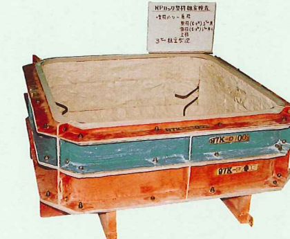
3ton型(基本タイプ)型枠
