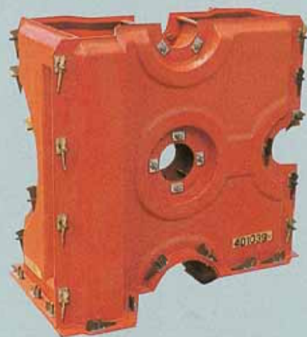
型枠組立完成
